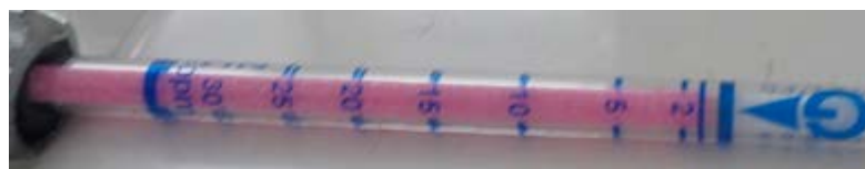
メンテナンス前アンモニア濃度 1ppm (男子小便器受尿部)
