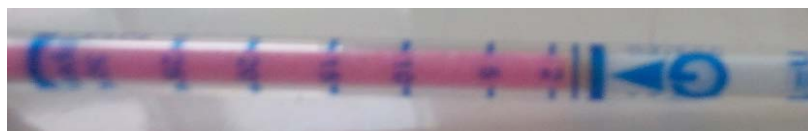
メンテナンス前アンモニア濃度 2ppm (男子小便器床接合部)
