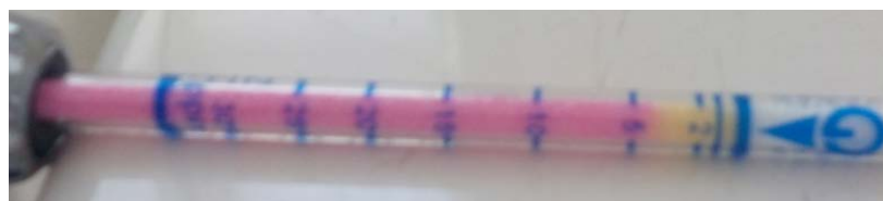
メンテナンス前アンモニア濃度 4ppm (男子小便器床接合部)
